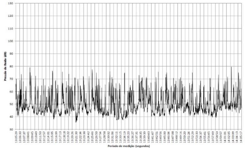
Medição de ruído externo durante o período de uma hora, como frequência de leitura a cada segundo, totalizando 3600 leituras. Aparelho: Decibelímetro com Data Logger ITDEC-4010.
