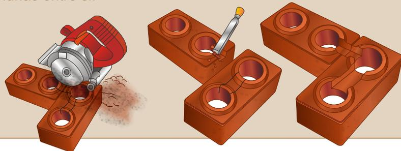
A cada 50 centímetros de parede erguida, a interligação das colunas pelos grampos, é a garantia de maior estabilidade na obra.
