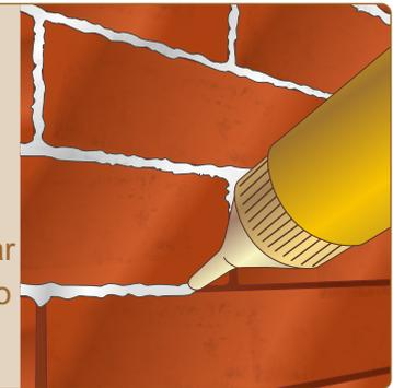
A massa para rejuntar pode ser a usada em azulejos, massa branca misturada a corantes ou simplesmente uma mistura de solo-cimento.
