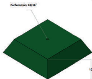
Bloque de anclaje
