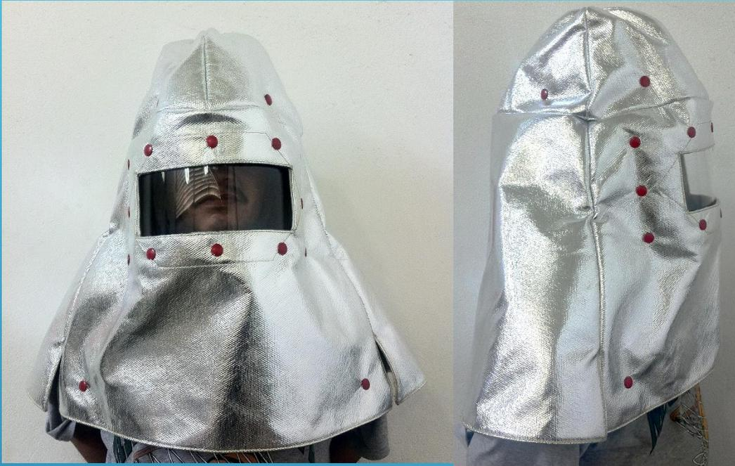
ESCAFANDRA DE KEVLAR ALUMINIZADO 1081 Gentex. Refleja el 90% del calor radiante. Forro de tela Nomex o Algodón. Mica intercambiable de acrílico de 36 x 16 cms. Con o sin casco de fibra de vidrio integrado. (También se fabrica en Nomex IIIA)
