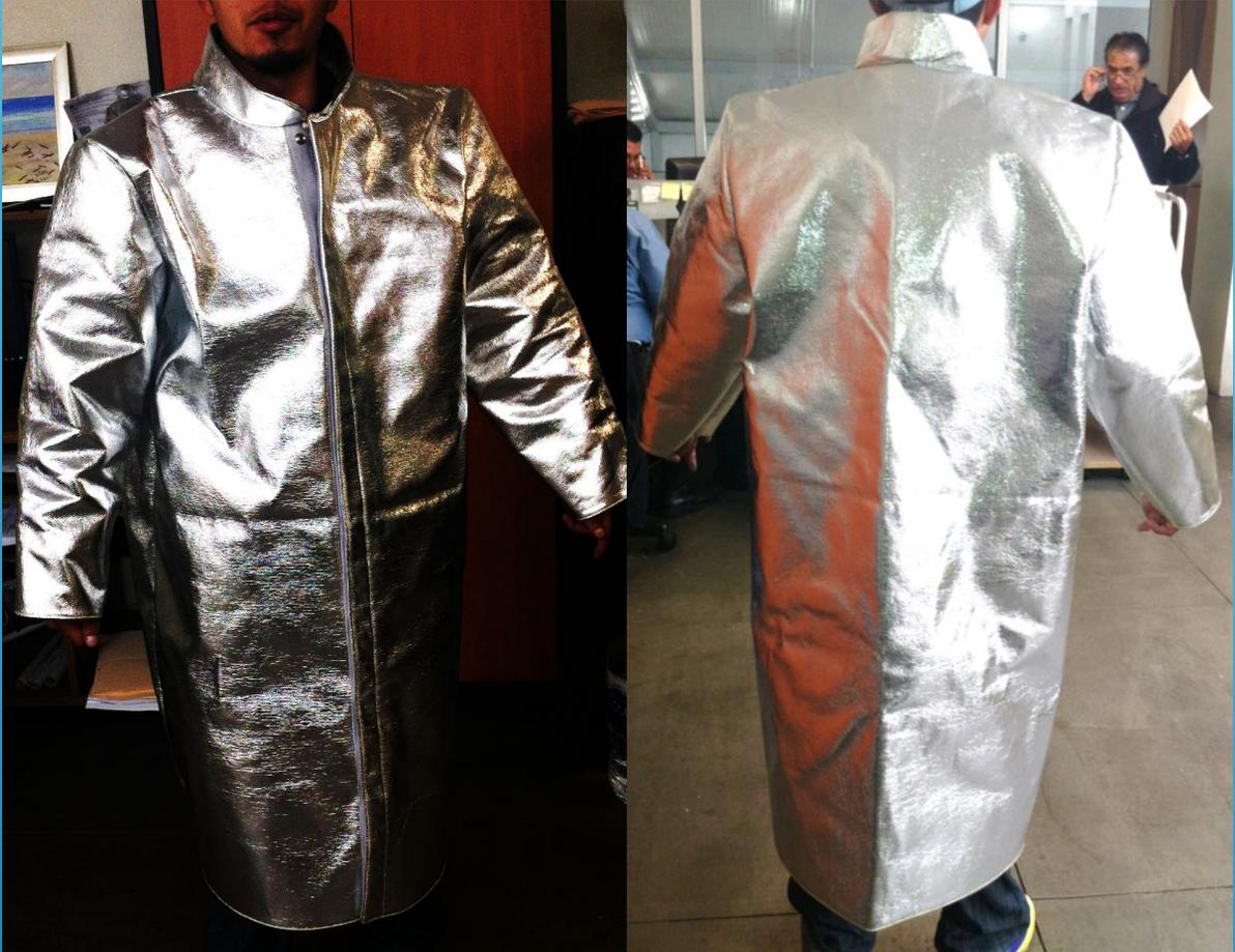
Chamarra de 120cms tipo "JAPONESA" fabricada de Kevlar o rayón Aluminizado Gentex, para trabajos cercanos a una fuente radiante de calor con altas probabilidades de salpicaduras de metal fundido (splash), se necesita contar con una protección segura. Refleja el 90% del calor radiante y tirantes de el mismo material cosido con hilo kevlar sin forro y con forro de Nomex.
