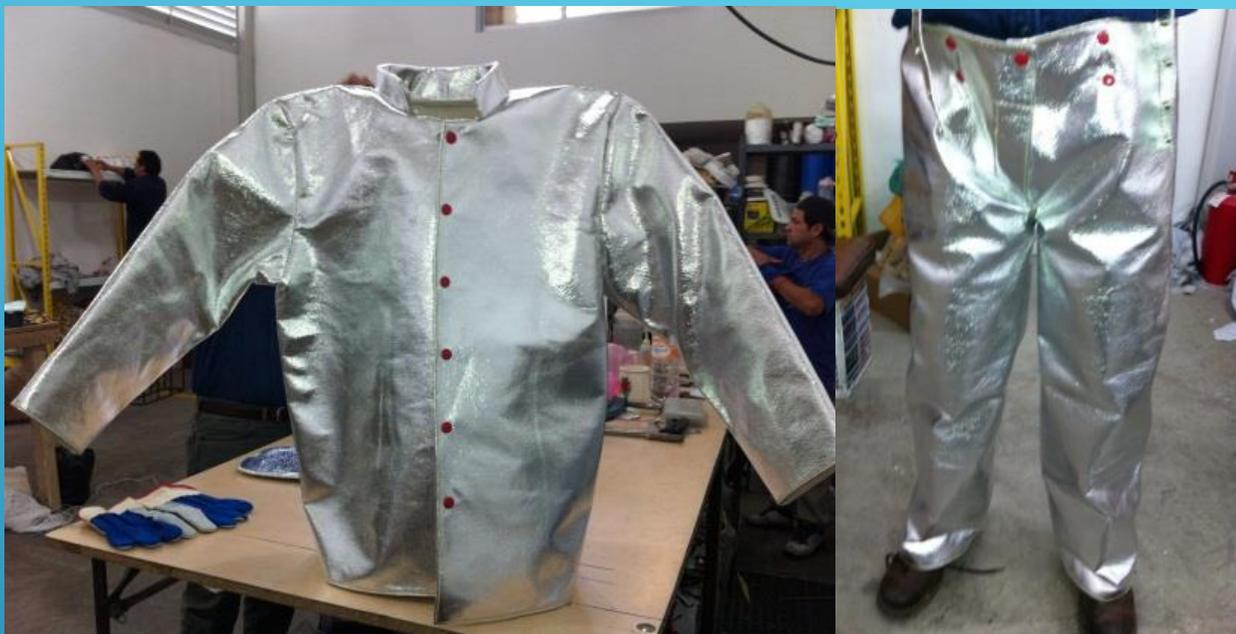
PANTALON Y CHAMARRA DE KEVLAR ALUMINIZADO 1081 Gentex, para trabajos cercanos a una fuente radiante de calor con altas probabilidades de salpicaduras de metal fundido (splash), se necesita contar con una protección segura. Refleja el 90% del calor radiante y tirantes de el mismo material cosido con hilo kevlar sin forro y con forro de Nomex.
