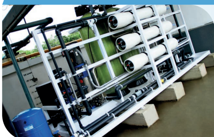
Sistema de Purificación de Agua / Ósmosis Inversa / Caudal: 120 m 3 /d / Segmento: Acuícolas
