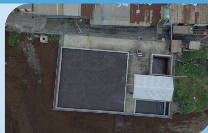
Sistema de Tratamiento de Aguas Residuales Industriales / Lodos Activos / Caudal 1500 m 3 /d / Segmento: Alimentos y Bebidas
