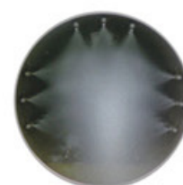
顶淋加侧喷式 C type top&side spray
