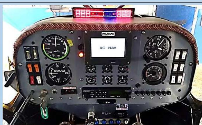
*Sistema GPS de Guia y Navegacion de ultima generación AG-NAV-Guia Lite para trabajos de aspersión de precisión.*
