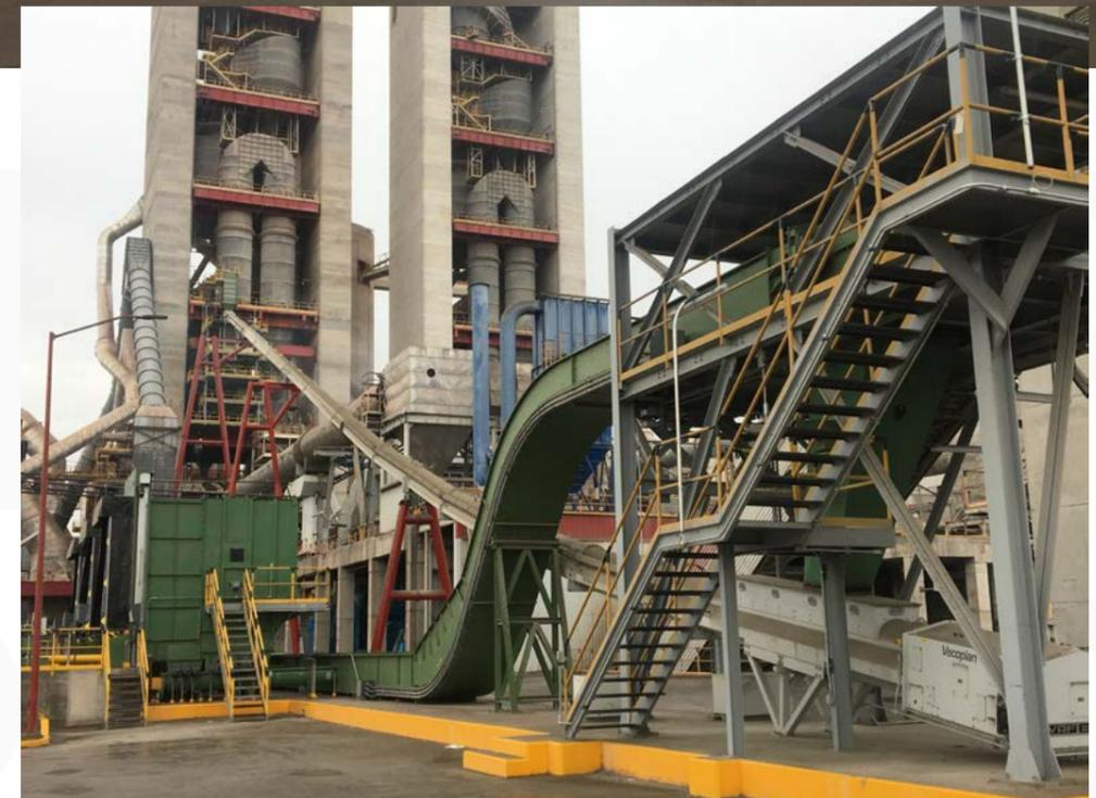
Diseño de **transportador con dimensiones amplias para manejo de materiales de muy baja densidad, puede ser secos o húmedos.**
