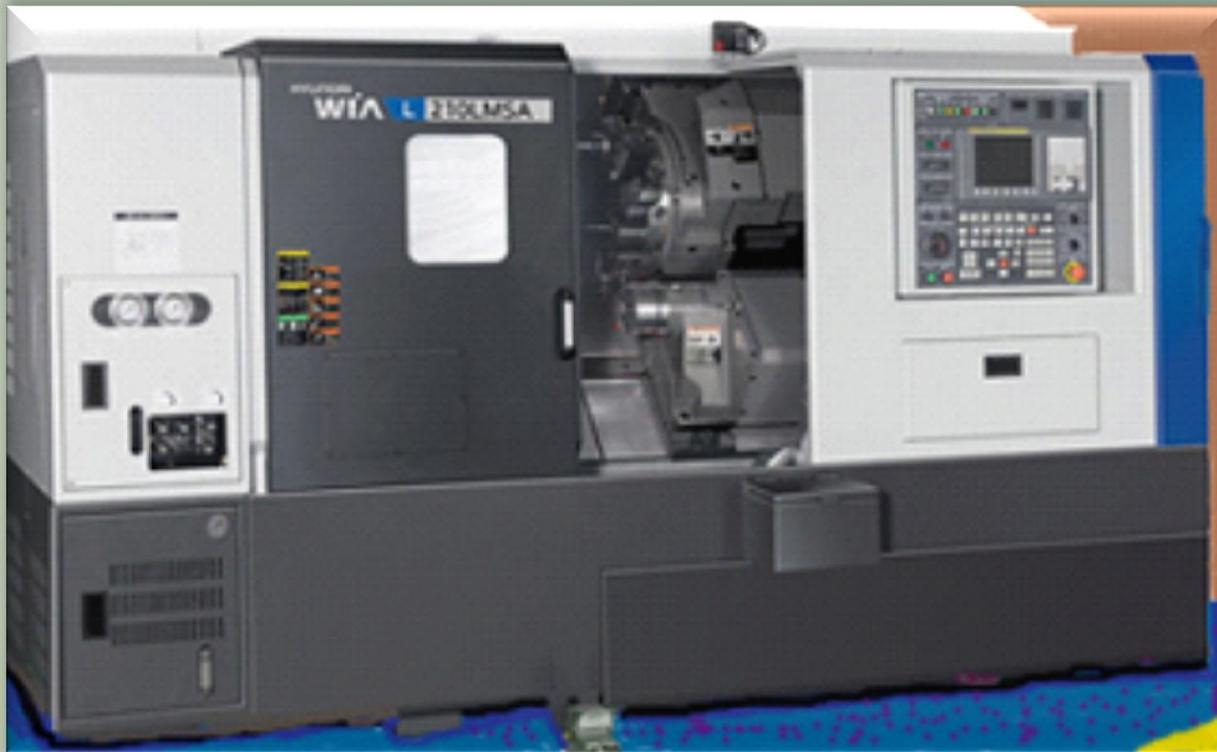
Unidad de mecanizado Torno Fresador
