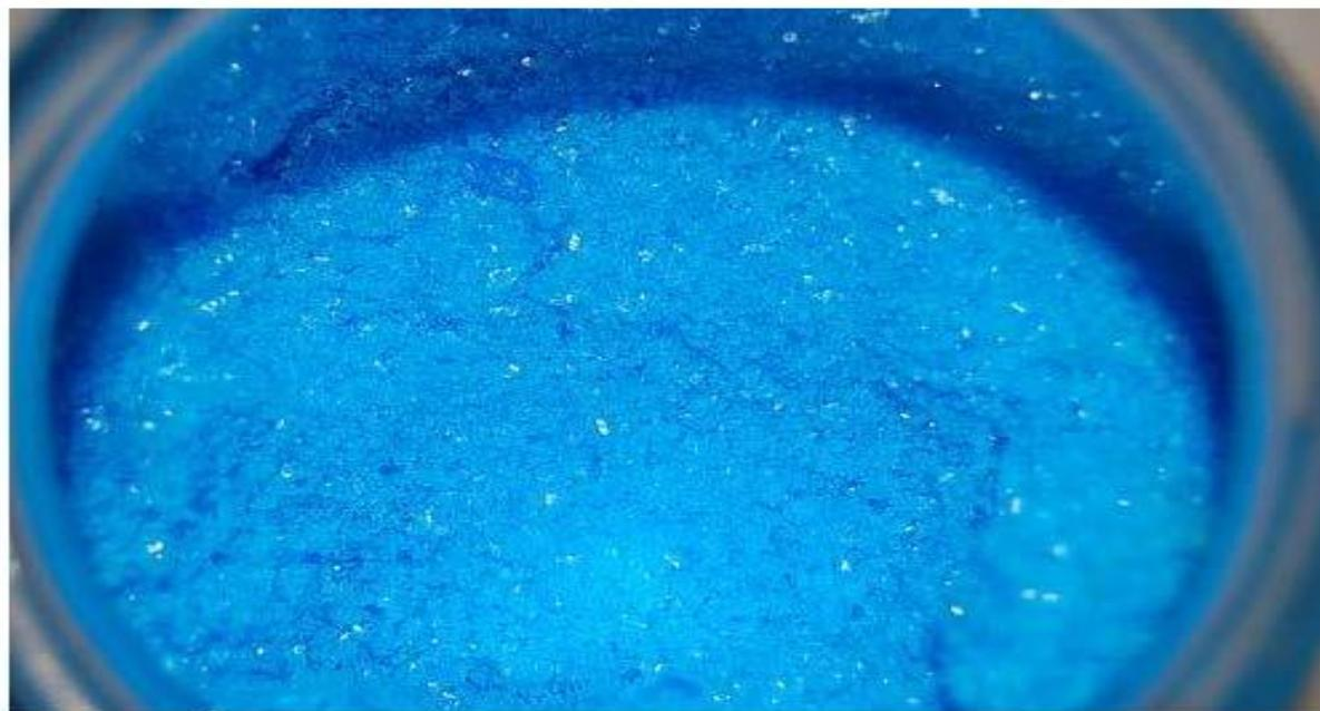
**Sulfato de cobre** ( $\text{CuSO}_4$ ): Agente oxidante de uso común en el pasado para el tratamiento de aguas residuales.
