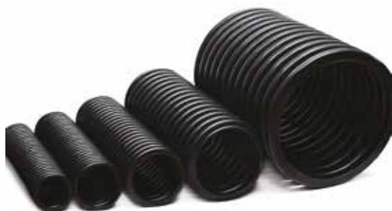
Fabricada com Polietileno de Alta Densidade (PEAD), a linha **techduto SD** atende aos principais requisitos das normas internacionais IEC 61386-24 (*Conduit System Buried Underground*) e EN 50086-24:1994 (*Conduit Systems for Cable Management, Particular Requirements for Conduit System Buried Underground*), tendo sido aprovado após rigorosos testes de compressão (450 N).
