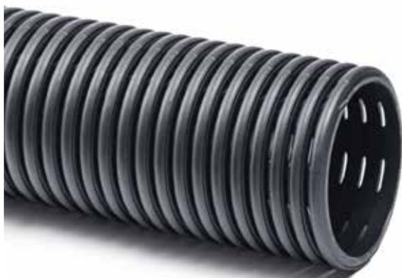
Produzidos em Polietileno de Alta Densidade (PEAD) e obedecendo a **NBR 15073** com referência da **ISO 21138-3**, os tubos corrugados para drenagem da linha **techdreno DW** têm formato anelar, alta resistência e possuem superfície lisa interna, o que aumenta a velocidade de vazão, sendo indicados para as mais diversas aplicações de drenagem de água, tais como:
