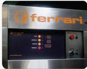
Microprocesador con 4 programas preestablecidos (seca, semiseca, húmeda y variable) con indicadores de tiempo; temperatura: superior e inferior; mando general y fusibles de seguridad, para una operación mas fácil y segura
