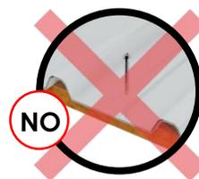
Asegure con Capelote solo en la cresta de la teja con autoperforante galvanizado en caliente, con arandela y neopreno
