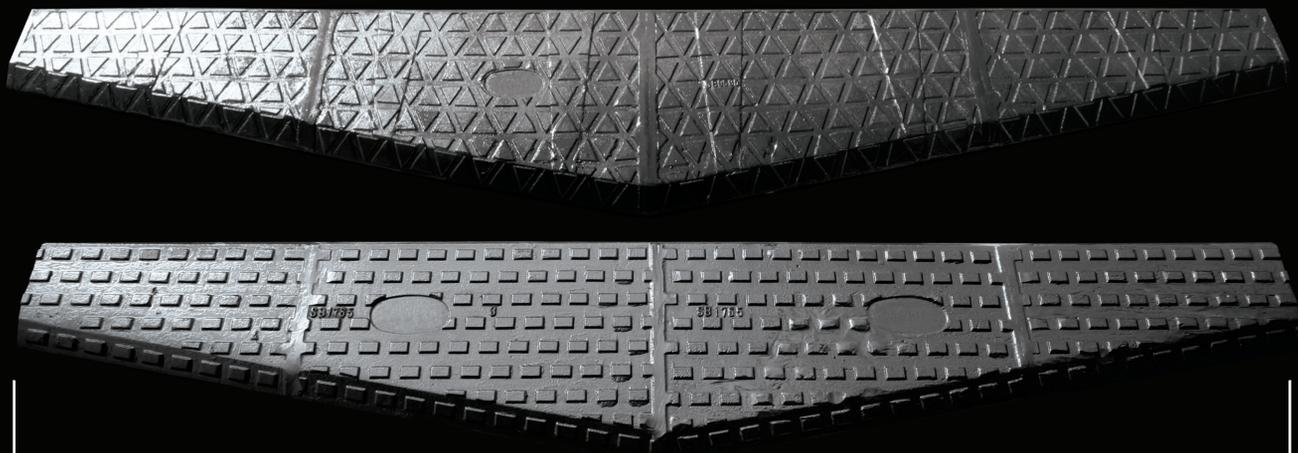
Fabricamos bordas em V (bico de pato) fundidas a base de Cr, Ni, Mo, com dureza 380/440 HB (brinel), para todos os tipos de carregadeiras. Também trabalhamos com lâminas retas para escavadeira em diversos tamanhos. Todas as peças são fabricadas para suportar impacto, abrasão e altas temperaturas.
