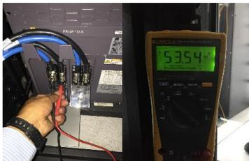
Medición de Voltaje en las fuentes del Equipo
