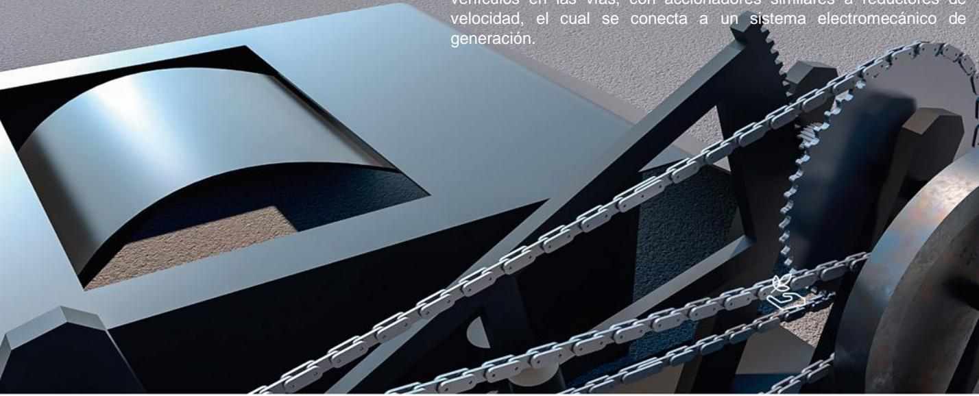
El sistema vehicular introduce mejoras significativas en el diseño de los activadores, sin daño a los neumáticos, incluso en contraflujo, menores requerimientos y costos de obra de instalación, dada la mínima intervención de la calzada y un sistema de mayor eficiencia operacional, ya que incorpora un sistema de relaciones para incrementar la velocidad rotacional.
