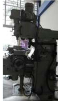
Erosionadora por penetración.
