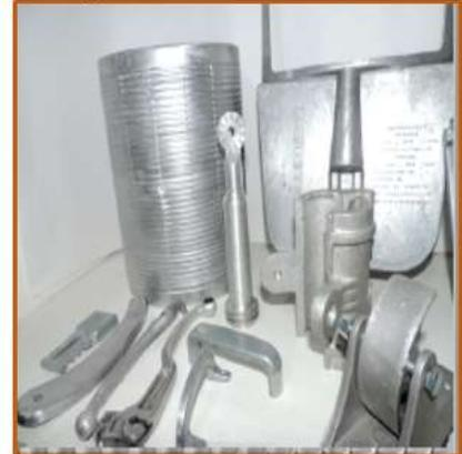
Fabricación de carcasas inyectadas en aluminio AlSi12.
