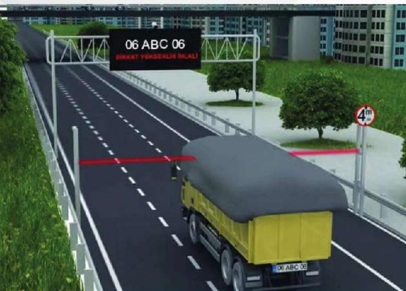
Protección de acceso a pasos bajo nivel, en función de la altura máxima establecida a nivel de gálibo. Sensado de altura máxima mediante la implementación de un sistema basado en escaner láser para detectar vehículos en movimiento que sobrepasen la altura permitida.
