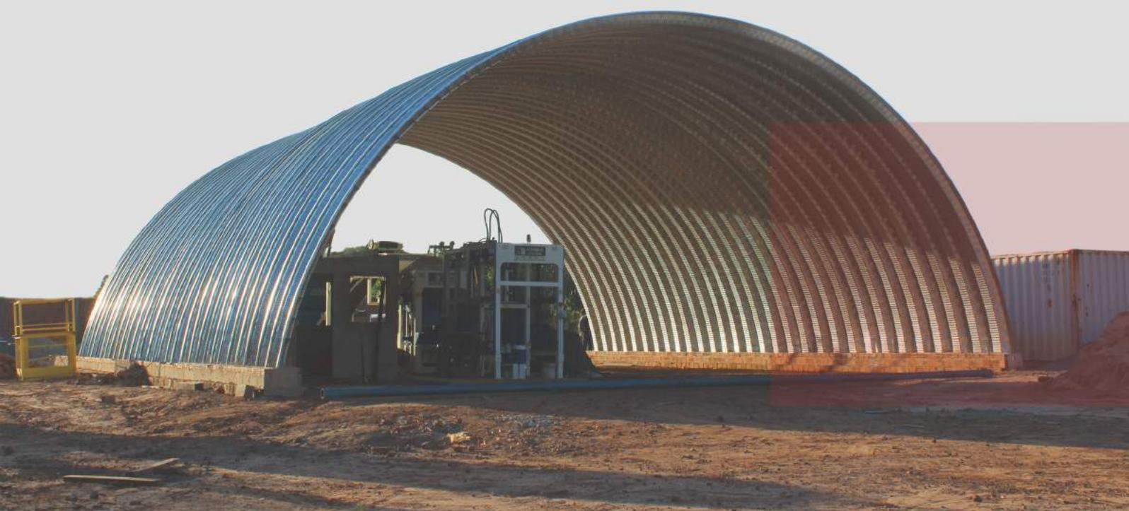
Uma grande particularidade deste equipamento é sua mobilidade uma vez que está instalado numa carreta e sempre pronto para funcionar. Esta mobilidade possibilita deslocar o equipamento para o local da obra e realizar a moldagem das telhas trapezoidais no próprio local.
