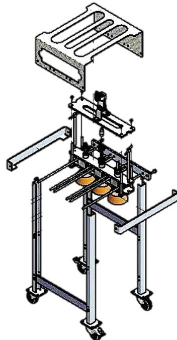
DISEÑO PROTOTIPO PULIDOR GRANITO 3 EJES
