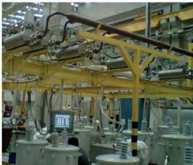
Montajes mecánicos, eléctricos, instrumentación y automatización, para adecuación del sistema de aceites completo existente para transformadores de distribución. Habilitación de todas las mediciones de flujo y nivel en todos los puntos de operación y desarrollo de sistema histórico de registros en SCADA. Enero de 2013
