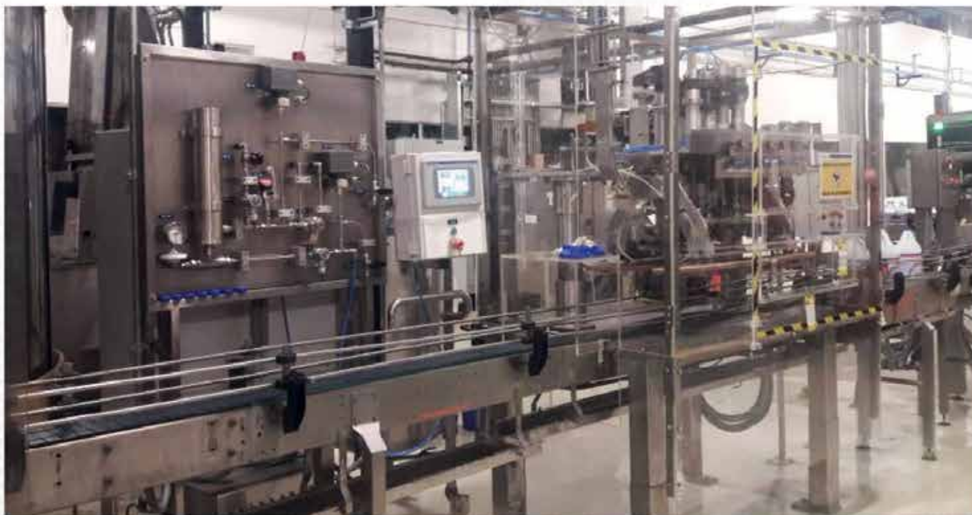
Diseño, fabricación, montaje y puesta a punto de sistema automático dosificador de fragancia. Septiembre de 2017
