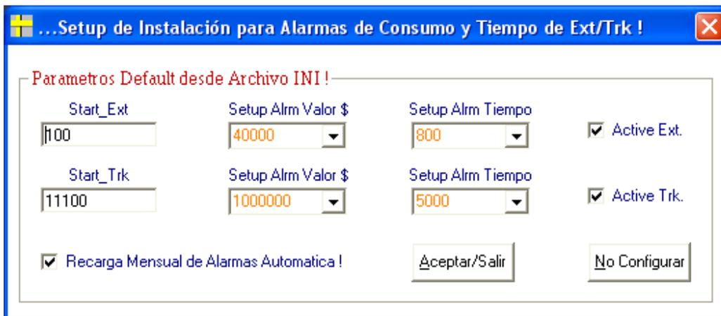
Figura 24 –Setup de Valores de Umbral para Alarmas.
