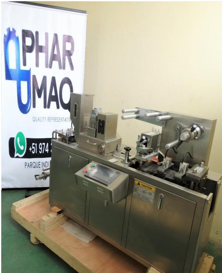
La máquina es adecuada para cápsulas, tabletas, inyecciones y dispositivos médicos. Usando el mecanismo de transmisión de potencia el cual elimina errores y ruidos de engranaje.
