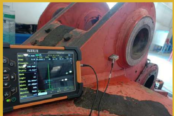
Inspeccion UT angular en estructura de material
