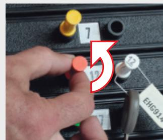
↓ Girando la clavija se activa el sistema y se libera la llave deseada.
