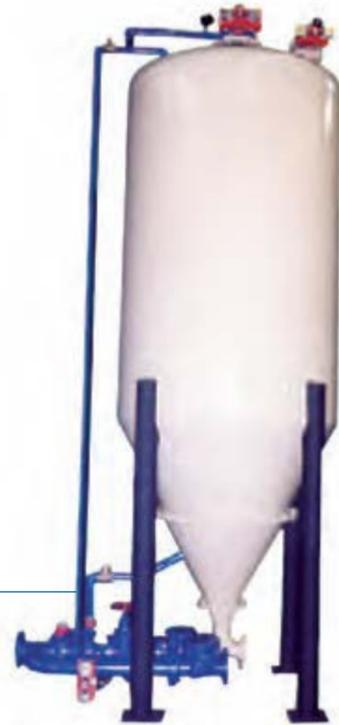
// Aerobombas para transporte **cemento**
