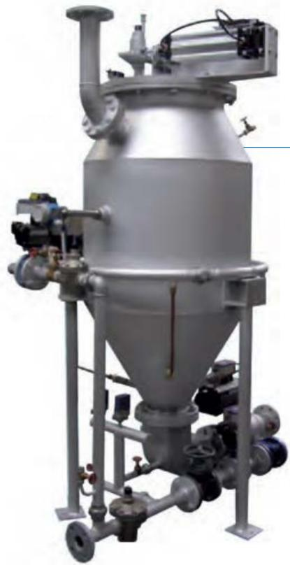
// Aerobombas para transporte **óxido magnesita**
