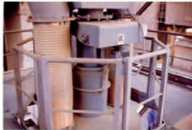
// Manguera telescópica **carga abierta dos conductos desempolvado**
