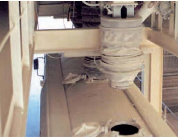
// Manguera telescópica carga camión cisterna
