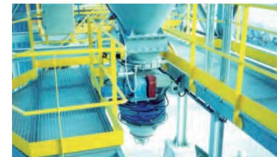
// Manguera telescópica carga a granel de arena caliza
