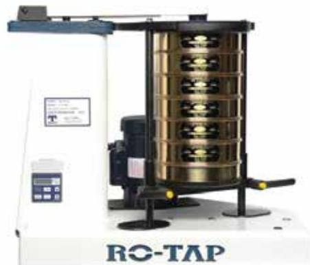
Esta determinación se puede aplicar para definir la cinética de molienda de muestras en que el grado de molienda esté definido en base al P80 (por ejemplo: 150 Qm) o muestras en que el grado de molienda se defina con respecto a una malla de referencia.
