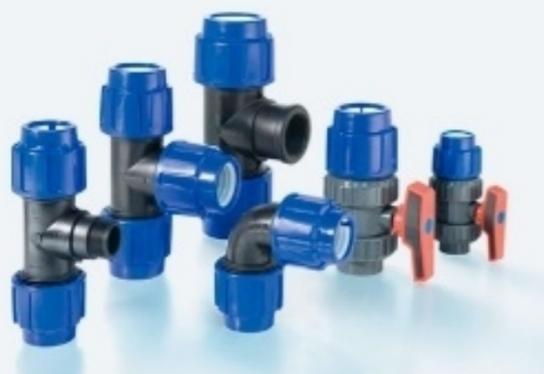
Los accesorios de compresión se utilizan para efectuar conexiones en la tubería M.I. HDPE® y M.I. GAS® en forma mecánica. El diámetro exterior es el que se mantiene constante, independientemente de la presión nominal, por lo que es un sistema de unión que abraza exteriormente la tubería.
