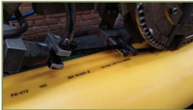
La poliamida 12 (PAU-12 no plastificada) es un polímero termoplástico de alta dureza y resistencia química; específicamente en aplicaciones de redes de gas se maneja la referencia VESTAMID NRG2105 de alto peso molecular, resistencia a la corrosión, a los hidrocarburos pesados, a la propagación lenta y rápida de grietas y al rayado e impacto.
