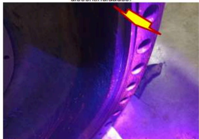
Fig.2 Inspeccion sup. Laterales libre de discontinuidades.
