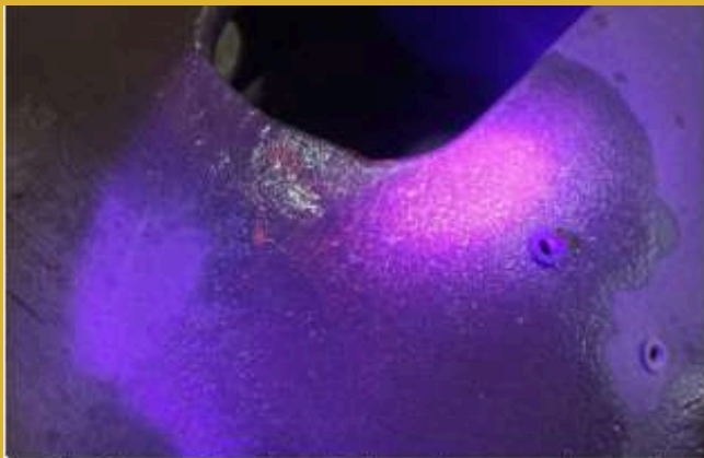
Fig.1 Inspeccion de estructura de cuerpo de rueda.
