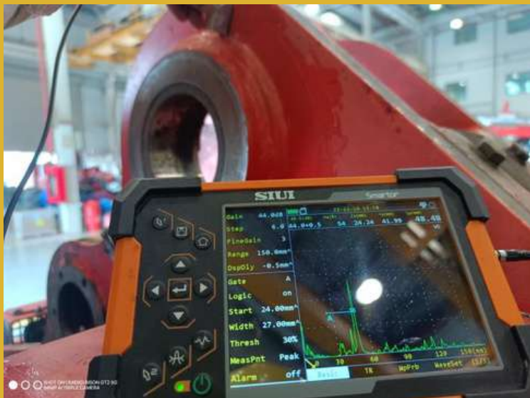
Inspeccion UT angular en estructura de material soporte superior e inferior asi como horquillas de acople, sin material discontinuidades
