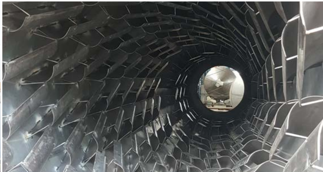
Sistema de Secado de Azúcar Orgánica - OTISA SUGAR MILL Organic Sugar Drying System - OTISA SUGAR MILL Sistema de Secagem de Açúcar Orgânico - OTISA SUGAR MILL OTISA Sugar Mill公司 - 有機糖乾燥系統
