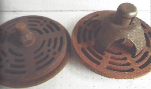
Valvulas antes y después de la Reparación.
