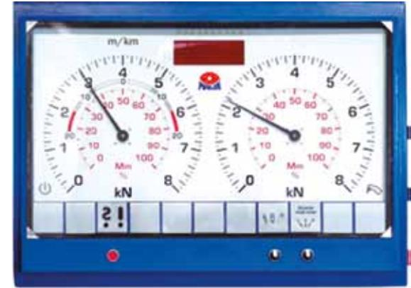
Indicador de multifunciones analógico para la visualización de valores de frenado, amortiguación y alineación, incluye elementos de control.
