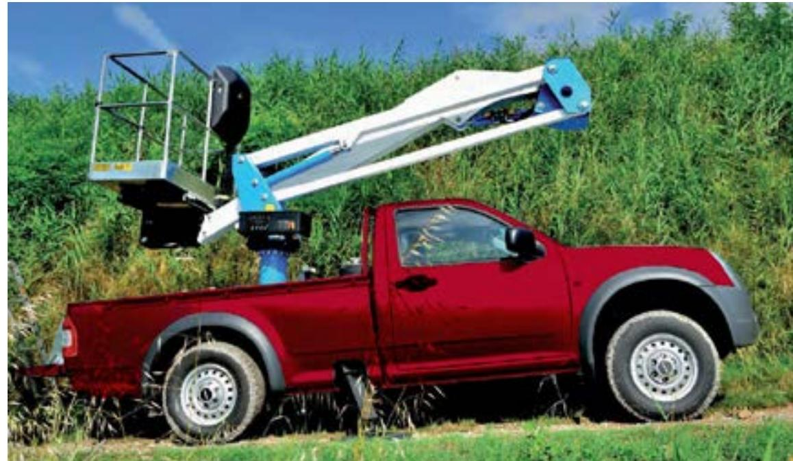
La plataforma elevadora de brazo articulado y telescópico modelo DE-11,8-220 ha sido diseñada y fabricada para ser instalada sobre el pick up de una camioneta Nissan Terrano cabina simple todo terreno 4x4; Se pueden realizar trabajos hasta una altura de 13 metros y alcanzar en la lateral hasta 5,5 metros, con una capacidad de carga de 220 kilos lo que permite 2 operadores más herramientas y/o materiales.
