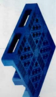
Medidas 120 x 100 x 16.5 cms., peso 21.2 Kg. Carga dinámica: 1200 Kg. Carga estática: 5000 Kg.
