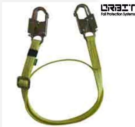
Eslinga de posición graduable, posee una hebilla de regulación en acero que permite ampliar o reducir la distancia de 1.30 a 1.80 cm, en el extremo del anclaje al arnés tiene gancho de apertura de 20mm, doble. ANSI Z 359-1 2007-ANSI A10.32, 2004.
