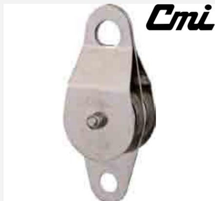
Polea doble con placas de acero que ofrecen mayor durabilidad para trabajos pesados y roldana en aluminio de 2". Especial para polipastos y actividades de rescate. Diámetro Cuerda máxima 13mm. Resistencia MBS 11000 Lbs 48,93 Kn. Código CMI RP119.
