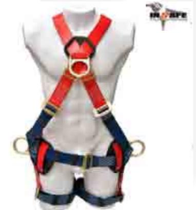
Arnés en reata en poliuretano posee una argolla dorsal "D" para la detención y restricción de caídas, y argollas laterales en "D" para posicionamiento a un punto fijo, argolla frontal para ascenso y descenso controlado, faja con diseño ergonómico.
