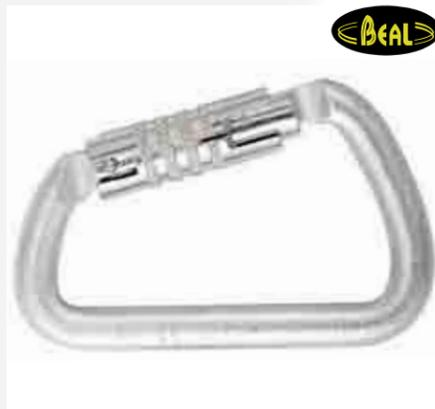
Mosquetón asimétrico de acero de gran capacidad y gran abertura, para las conexiones en soportes metálicos. Número de serie individual. Sistema Keylock. Resistencia eje mayor 52 kN. Resistencia eje menor 16 kN. Resistencia gatillo abierto 18 kN.
