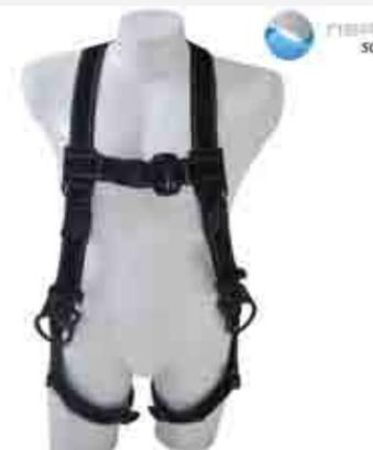
Arnés cuerpo entero fabricado en reata de aramida (Kevlar) resistente al fuego y cortes, hebillas automáticas y ligeras. Refuerzo en la espalda, con tres argollas estilo "D" para enganches y ajuste; 2 laterales y 1 dorsal. Etiquetas con sus normativas respectivas. Material: Kevlar y Nomex.
