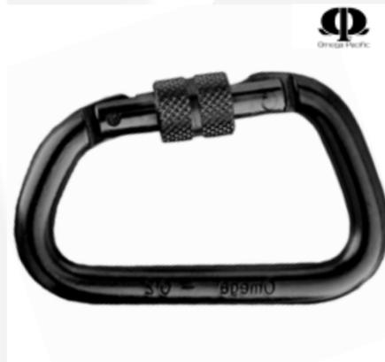
Forma D grande para un gran manejo, en una resistencia nominal de 72kN, con tratamiento térmico, de media carga probado (más de 8000 lbf.) El ½ "Gran D es un mosquetón de acero. Supera los estándares actuales de la NFPA. Cumple con las normas actuales de construcción NFPA1983. UL
