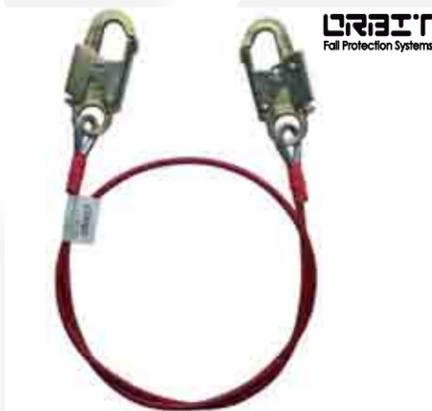
Eslinga de posición y restricción, en cable de acero galvanizado o inoxidable 6 x 19 con alma de acero, en el extremo del anclaje al arnés tiene gancho de apertura de 20 mm ganchos de doble seguro en acero o aluminio. ANSI Z 359-1 2007- ANSI A10.32, 2004.
