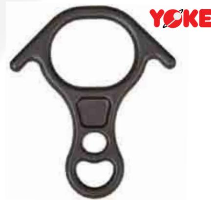
Con suficientemente capacidad para manejar las cuerdas más grandes. Cuernos extendidos en la parte de arriba del anillo que previene que la cuerda se deslice y bloqueé cuando se esta amarrado. Para Rappel y rescate. Resistencia 44,5 kn 10.000 lbs
