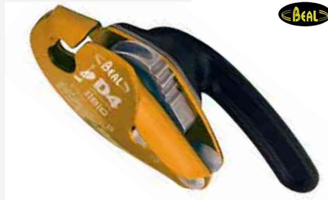
Descensor autobloqueante de leva para cuerda simple, con función antipánico. Carga máxima de trabajo de 130 kg con una cuerda de 9 mm y de hasta 200 kg para cuerdas de 10 a 12 mm. Función antipánico con 2 posiciones de bloqueo. Compatible con un amplio abanico de diámetros de cuerdas de 9 a 12 mm (EN12841-C). Palanca de control larga, para una acción más progresiva. Inserción de la cuerda sin desenganchar el dispositivo. CE EN 341 EN 12841
