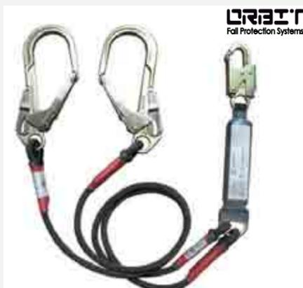
Cuerda estática de poliéster con recubrimiento en Kevlar cal. 12 mm, en el extremo del anclaje al arnés tiene gancho de apertura de 20 mm y al otro extremo se puede disponer de ganchos de seguridad compatibles (tipo C), los ganchos son de doble seguro en acero o aluminio, automáticos o accionamiento con dos movimientos. ANSI Z 359-1 2007- ANSI A10.32, 2004
