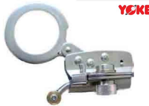
Salvacaídas en acero inoxidable, para soga de nylon cilíndrica de 11mm, 12 mm- 14mm y 16 mm con sistema de cierre de perno y rosca, conexión en argolla frontal. Permite subir y bajar sobre un soporte vertical sin intervención del usuario, en caso de caída el sistema se bloquea automáticamente.
