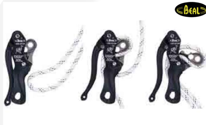
Descensor autobloqueante de leva para cuerda simple, con función antipánico. Carga máxima de trabajo de 130 kg. Función antipánico con 2 posiciones de bloqueo. La velocidad de descenso máxima autorizada es de 2 m/s. Compatible con un amplio abanico de diámetros de cuerdas de 9 a 12 mm (EN12841-C). Palanca de control larga, para una acción más progresiva. Número de serie individual.
