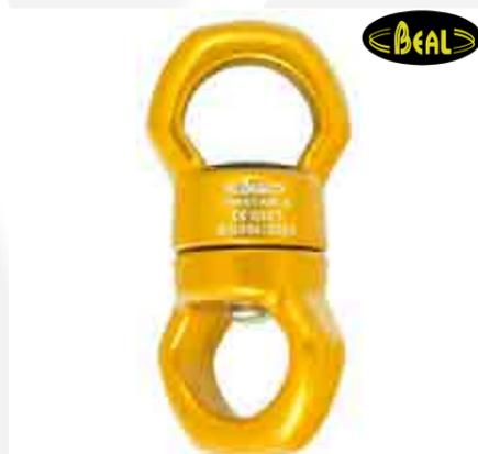
Eslabón giratorio de aluminio, compacto, con rodamiento de bolas para un rendimiento excelente incluso con carga. Número de serie individual. Cojinete de balineras. Peso: 88 g
