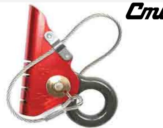
Ascendedor de ajuste fácil y rápido en aluminio. Con cable reversible, pines y orificios para evitar la suciedad pegada en la cuerda. Presentación en aluminio Resistencia: 33.3KN Bloqueador tipo leva, para una sola cuerda de 11 mm a 16 mm de diámetro. Permite instalar y desinstalar en cualquier parte de la línea de vida o trabajo. Punto de sujeción grande. Para cuerda de 11 y 16mm.
