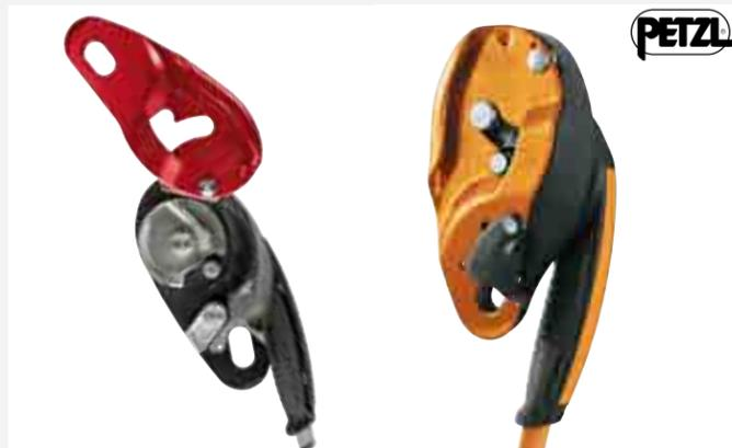
Descensor autofrenante con antipánico, provisto de una empuñadura multifunción que permite controlar el descenso, desplazarse más fácilmente en un plano inclinado u horizontal e inmovilizarse en el puesto de trabajo sin llave de bloqueo. Dispone de una leva indicadora de error para limitar el riesgo de accidente y de un gatillo de cierre para que el aparato no se pierda a la vez que facilita la instalación de la cuerda durante el paso de fraccionamientos.
