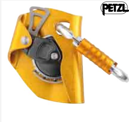
Con su sistema de bloqueo, el aparato se desplaza libremente a lo largo de la cuerda, sin intervención manual, para seguir al usuario en sus desplazamientos. En caso de choque o aceleración brusca, el ASAP se bloquea en la cuerda e inmoviliza al usuario. CE EN 353-2, CE EN 12841 type A, EAC.
