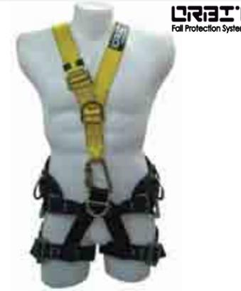
Arnés antiácidas de sujeción pélvico-pectoral de cinco puntos de anclaje, uno ventral para suspensión con cuerda, dos loop laterales, uno en la espalda para líneas de vida y uno en el pecho para ascenso y rescate. Faja lumbar y perneras acolchadas para largos periodos de tiempo en suspensión, hebillas de ajuste rápido en espalda.
