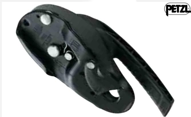
Descensor autofrenante compacto, provisto de una empuñadura multifunción que permite controlar su velocidad de descenso y posicionarse en el puesto de trabajo sin llave de bloqueo. El gatillo de cierre limita el riesgo de perder el aparato y facilita el paso de fraccionamientos. Además, el retroceso automático de la empuñadura limita los riesgos en caso de acción involuntaria. EN 341 clase A, CE EN 12841 type C, NFPA 1983 Technical Use, EAC.
