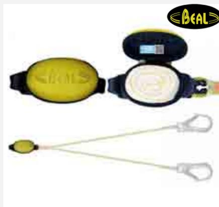
Absorbedor de energía con estructura de malla. La energía se absorbe gracias al desgarramiento controlado de la trama de la malla durante el despliegue. Bolsa semirrígida de apertura fácil. Inspecciones integrales sencillas. Secado rápido una vez desenrollado. Marcado con un número individual. NORMA: CE EN 355
