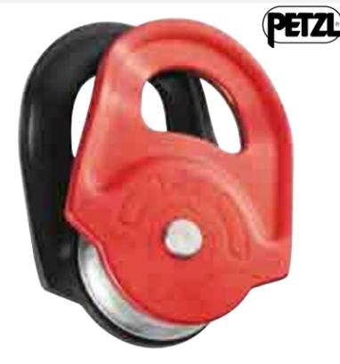
La polea RESCUE, de alto rendimiento, ideal para el rescate, el izado de cargas pesadas y la utilización intensiva. Diseñada para maniobrar con cargas pesadas o para una utilización intensiva. Roldana de gran diámetro con rodamiento de bolas estanco. CE EN 12278, UIAA
