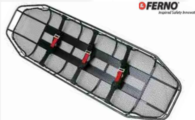
Elaborada en acero al carbono, estructura geometrica tubular de 19 mm, de alta resistencia. El soporte para paciente es una malla de acero al carbon, que lo protege de obstrucciones a su paso. Por sus materiales de construcción se puede utilizar en aire o agua, Resistencia probada de 408 Kg. Permite adaptar el sistema de flotacion para trabajo en el agua.
