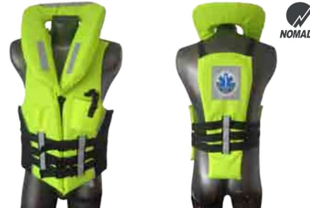
Lona Huracán amarillo limón con pigmentación grado 5, respaldo de poliuretano y tratamiento antiácido, alta resistencia a la tracción e intemperie, con nuquera. Lamina de espuma de poliuretano 10 mm x 3. Cinta en tela reflectiva de 1", hilo Nylon bondeado # 60 Abdominal; 3 hebillas plásticas de alta resistencia. Correas en polipropileno tejido ultra compacto: 3 cinturones abdominales, 1 cinturón de entrepierna. "Logo Institucional".
