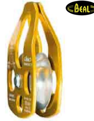
Polea simple de grandes dimensiones con placa lateral móvil. Placas laterales de aluminio. Eje y arandela de acero inoxidable. Excelente rendimiento, gracias a la roldana montada sobre un casquillo de bronce. Ø max ≤ 16 mm. EN12278 : 1998.
