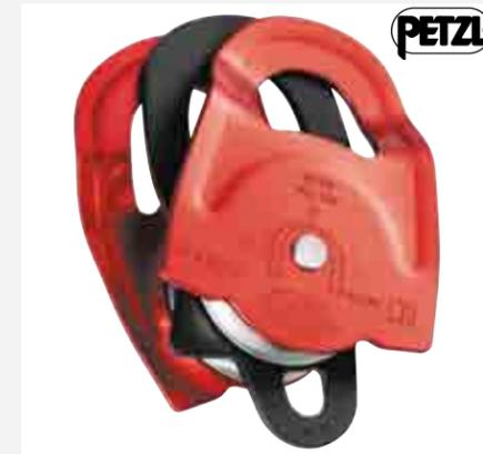
Polea doble de alta resistencia destinada a los profesionales del rescate para realizar montajes antirretorno con una importante desmultiplicación de carga. Puede admitir hasta tres mosquetones para facilitar las maniobras. CE EN 12278, NFPA 1983
