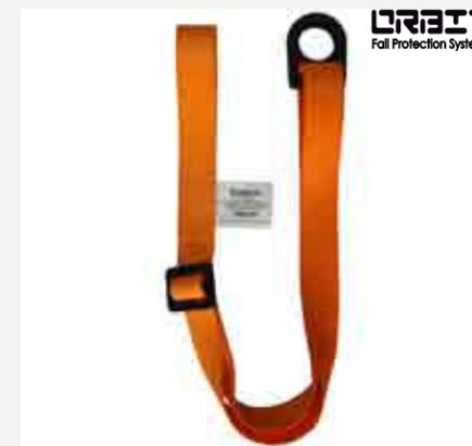
Adaptador de anclaje dieléctrico, de alta resistencia, posee una hebilla en acero con recubrimiento en nylon que facilita graduar la longitud, con argolla tipo "D" sin dieléctricidad. NORMA ANSI Z 359-1 2007- ANSI A10.32, 2004
