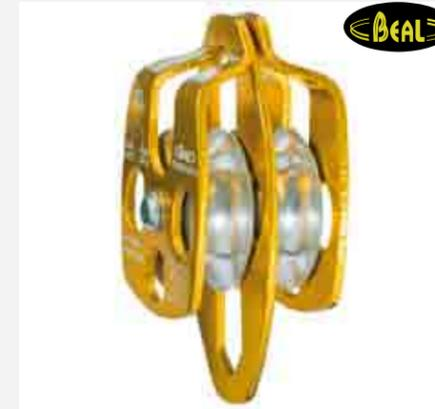
Polea doble de grandes dimensiones con placa lateral móvil ideal para polipastos. Placas laterales de aluminio, eje y arandela de acero inoxidable. Excelente rendimiento, gracias a la roldana montada sobre un casquillo de bronce. Ø max ≤ 16 mm. EN12278 : 1998.
