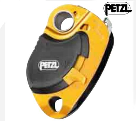
Diseñada para poder instalar la cuerda cuando la polea está fijada al anclaje. Con la roldana de gran diámetro y un excelente rendimiento, está especialmente adaptada para el izado de cargas pesadas o en polipastos. La placa lateral bloqueada impide la abertura de la polea mientras se está utilizando. CE EN 567
