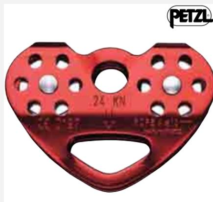
La polea TANDEM está diseñada para desplazarse eficazmente y sin sacudidas por tirolinas de cuerda. Buen rendimiento gracias a las roldanas de aluminio montadas con cojinetes autolubricantes. El punto de enganche puede admitir hasta tres mosquetones para facilitar las maniobras. CE EN 12278, UIAA
