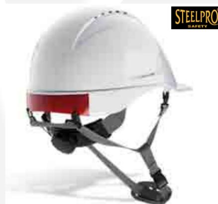
Para trabajo en altura están diseñados de termoplástico de ingeniería ABS de alta resistencia a impactos. Posee suspensión tipo Roller que permite un ajuste simple y adecuado. Posee reflectante termoplástico ubicado en la zona posterior del equipo sobre la nuca. Visera corta para trabajos en altura, espacios confinados y alto voltaje.
