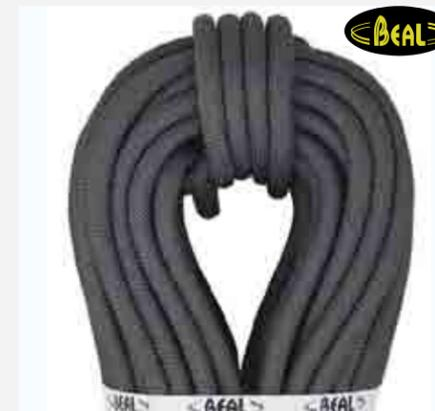
La RAIDER TACTIC se ha podido certificar como cuerda semiestática de tipo A, al reducir el grosor de la funda de aramida y aumentar la proporción de alma. Soporta una masa de 100 kg expuesta a una temperatura de 400° C, resistencia de unos 1.500 daN, encogimiento al agua 3,7 %.
