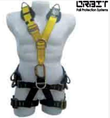
Arnés antiácidas de sujeción pélvico-pectoral de siete puntos de anclaje, uno ventral para suspensión, dos laterales tipo "D", uno en la espalda para la línea de vida, uno en el pecho para ascenso y rescate y dos en los hombros tipo triangulo para rescate, faja lumbar y perneras acolchadas para largos periodos de tiempo suspendido.
