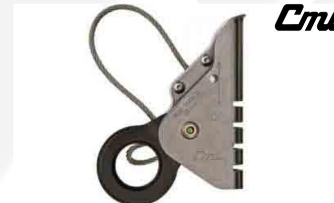
Ascendedor de ajuste fácil y rápido en acero. Con cable reversible, pines y orificios para evitar la suciedad pegada en la cuerda. Presentación en acero Resistencia: 33.3 KN. Sirve para cuerda de 11 y 16mm. Bloqueador tipo leva, para una sola cuerda de 11 mm a 16 mm de diámetro. Permite instalar y desinstalar en cualquier parte de la línea de vida o trabajo. Punto de sujeción grande, para mosquetones múltiples. Ideal para bloquear líneas de vida.
