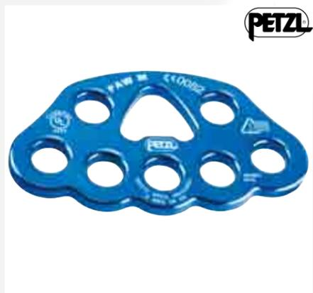
Permite organizar una estación de trabajo y disponer de forma sencilla, de un sistema de anclaje múltiple. Orificios de 19 mm para dejar pasar el casquillo de seguridad de la mayoría de los mosquetones. Carga de rotura: 36 kN. CE, NFPA 1983
