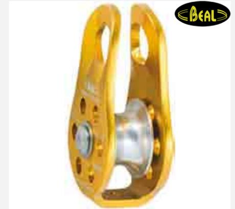
Diseñada para poder instalar la cuerda cuando la polea está fijada al anclaje. Con la roldana de gran diámetro y un rendimiento importante, está especialmente adaptada para el izado de cargas pesadas o en polipastos. La placa lateral bloqueada bajo carga impide la abertura de la polea mientras se está utilizando. CE EN 567
