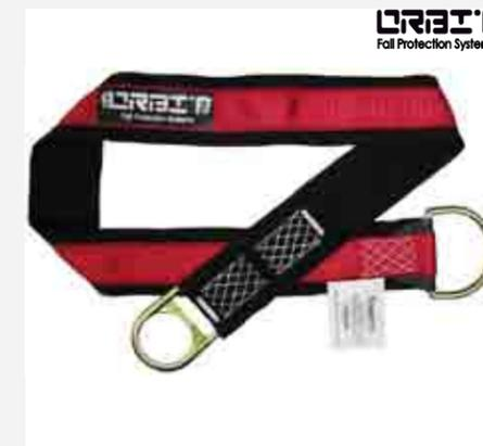
Estrangulador de postes diseñado para proporcionar un anclaje temporal, fabricado en reata reforzada de 70 Y 45 mm, largo según referencia, con argolla tipo "D" en un extremo proporcionando compatibilidad al anclaje. NORMA ANSI Z 359-1 2007- ANSI A10.32, 2004
