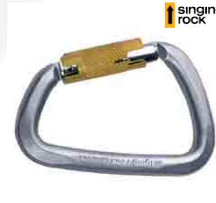
Mosquetón con cierre triple (key lock), plateado con cinc, número único de identificación para facilitar el registro de las inspecciones. Uso trabajos en altura- Verticales- Poda- montaje de andamios- Construcción - Industria. Abertura de gatillo: 25 m.m.
