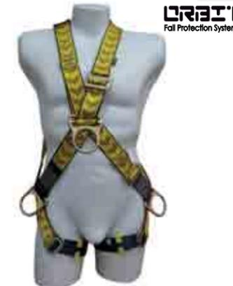
Arnés multipropósito de 4 puntos de anclaje con argolla tipo "D", uno en la espalda para detención de caídas, dos laterales en la cintura y uno en el pecho para rescate ascenso y descenso por estructuras; en los enganches se conectan los sistemas y dispositivos anti-caídas regulable en piernas, cintura y pecho.
