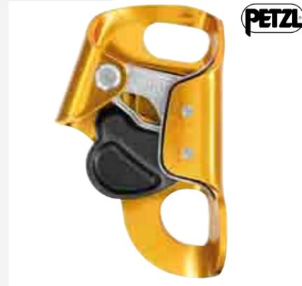
Se utiliza como complemento de un puño ASCENSION para el ascenso por cuerda. Leva dentada con ranura de evacuación para optimizar el funcionamiento en cualquier condición. Refuerzo de protección antidesgaste de acero inoxidable que protege la zona de rozamiento de la cuerda. CE EN 567, CE EN 12841 type B, EAC.
