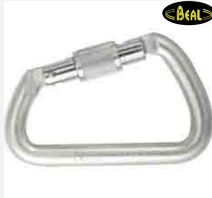
Mosquetón asimétrico de acero de gran capacidad y gran abertura, para las conexiones en soportes metálicos. Gracias a su gran capacidad, permite integrar diferentes elementos. Cierre a rosca Screw lock, número de serie individual, sistema Keylock. Resistencia eje mayor 52 kN.
