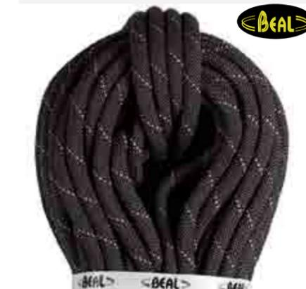
Cuerdas semiestáticas de tipo B especialmente diseñadas para los descensos rápidos de las fuerzas especiales desde helicópteros. Su funda de aramida no se funde, incluso bajo el efecto de una pieza metálica recalentada por el descenso. Ofrece un alargamiento moderado para facilitar las intervenciones y los descensos en rápel a velocidad moderada.
