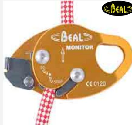
Anticaídas deslizante accionado mediante leva, minimiza la abrasión de la cuerda. La placa lateral oscilante facilita la instalación en la cuerda. El gatillo lateral fija el MONITOR en el lugar de trabajo. Bloqueo inmediato de una caída o un deslizamiento a baja velocidad. Marcado con un número individual único. EN353-2, EN12841-A - 100 kg - 11-13 mm de diámetro (EN1891).
