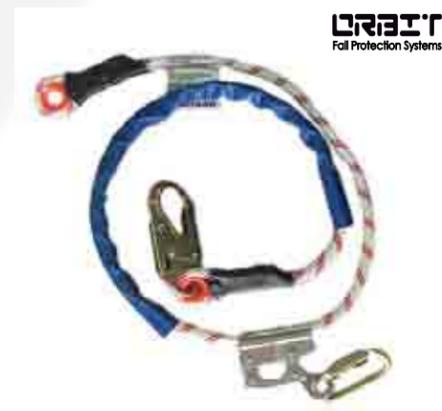
Eslinga de posición y restricción, se asegura de las argollas laterales en "D" de la cintura del arnés para dar posicionamiento durante el trabajo por medio del manostop; en un extremo tiene acople y el otro extremo un mosquetón en acero o aluminio de apertura automática. ANSI Z 359-1 2007- ANSI A10.32, 2004.
