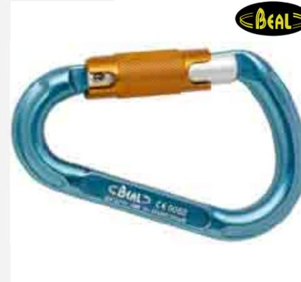
Mosquetón asimétrico de aluminio de gran capacidad y abertura. Su amplia superficie de trabajo y su forma HMS facilitarán la realización de nudos ballestrinque y nudos dinámicos. Triple cierre 3-MATIC, número de serie individual, sistema Keylock, resistencia eje mayor 26 kN, resistencia gatillo abierto 8 kN.
