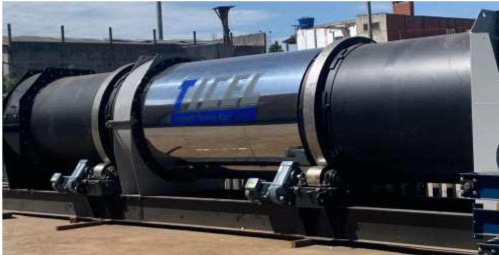
Secador apoiado por roletes de tração e apoiado em anéis externos ao corpo do secador.
