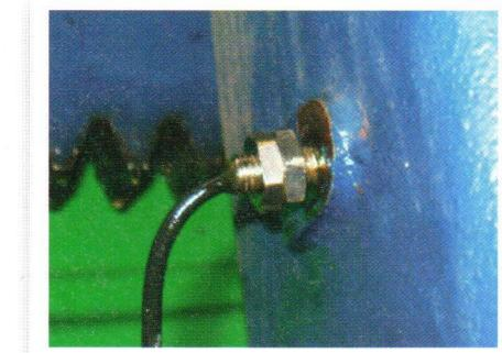
**Sensor de velocidad / Speed Sensor**
