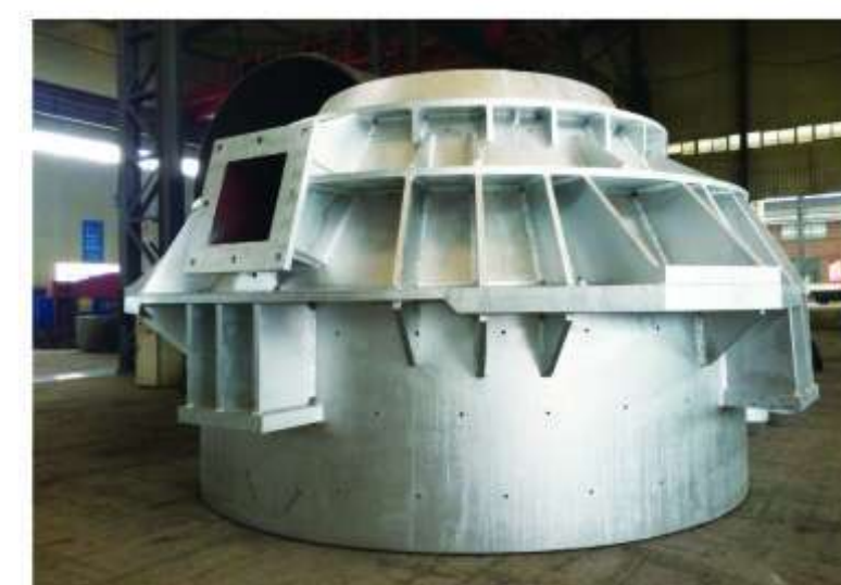
渣罐 slag ladle
