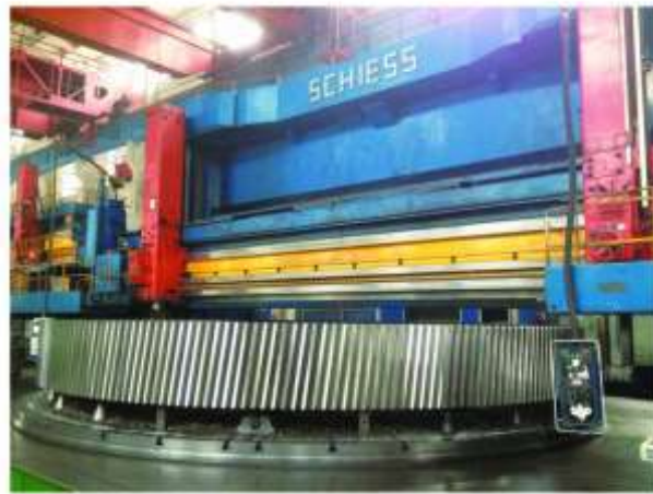
Φ10m数控立车 Φ10m CNC horizontal lathe
