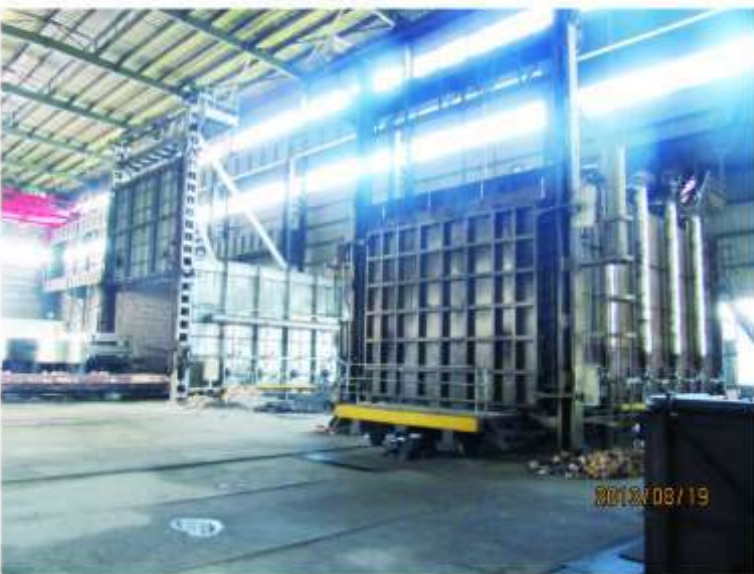
热处理能力： 轴类：φ800/L4000mm以内的各种轴类、轧辊等的调质、表淬； 圈类：φ6000mm以下各种轴承辊道、齿圈的调质、表面淬火； 齿类：可进行模数5以上齿类零件的表面淬火，淬火深度1~15mm； 调质零件尺寸：6000×3000×2000 最大调质半齿圈直径8米。
