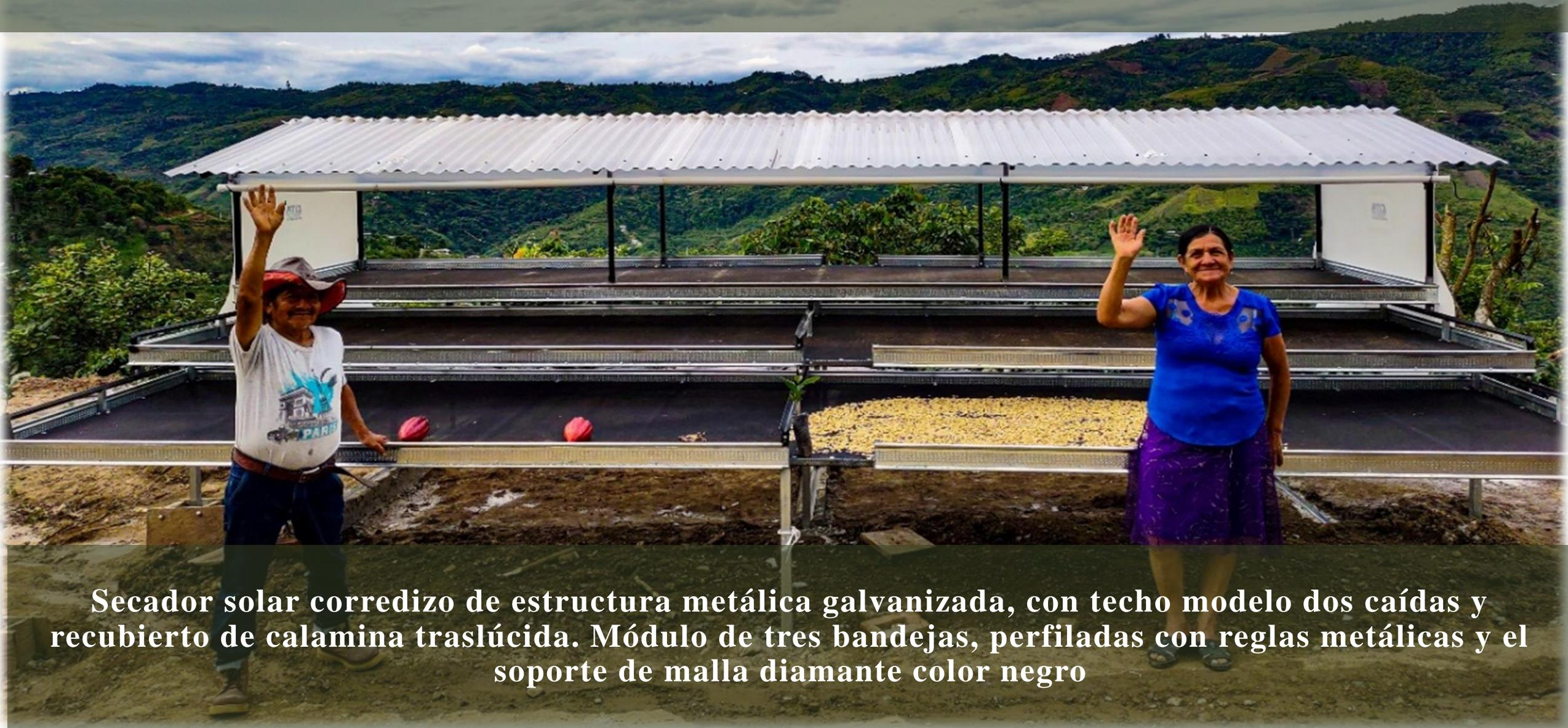
**Secador solar corredizo de estructura metálica galvanizada, con techo modelo dos caídas y recubierto de calamina traslúcida. Módulo de tres bandejas, perfiladas con reglas metálicas y el soporte de malla diamante color negro**
