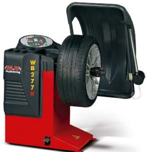
Balancadora digital por microprocesador, de lanzamiento único y ciclo completamente automático. Su display permite visualizar de manera simultanea los valores de peso y posición. Incluye palpador externo para ingreso de parámetro automático. Ocupa poco espacio en taller, y con un accesorio, es recomendada para balanceo de motos. Diferente a otras balancadoras, esta trabaja ruedas pesadas/grandes de camionetas.
