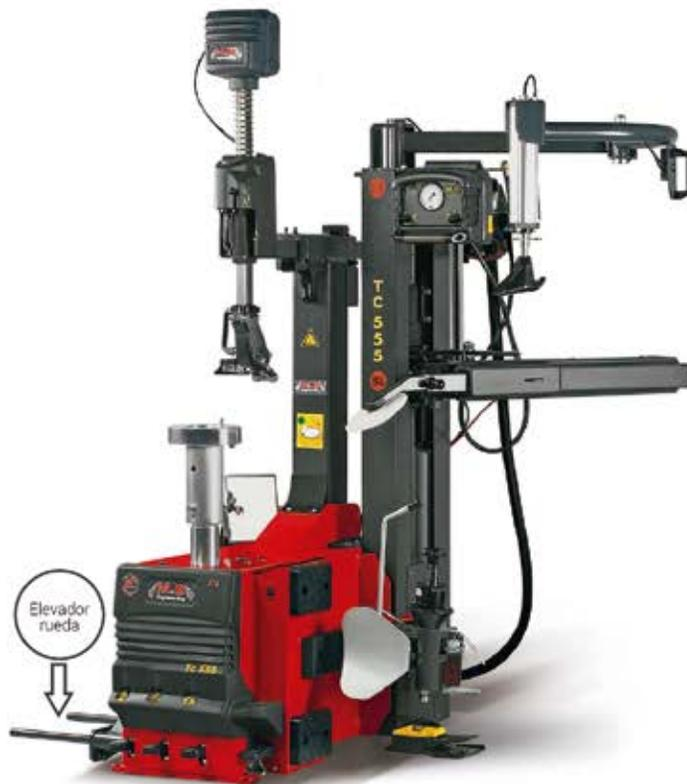
Desmontadora automática con tecnología leverless, sistema autocentrante a bloqueo central. Esta herramienta está diseñada para trabajar todas las ruedas de autos livianos. Incluye brazo neumático y elevador de rueda para facilitar labores al operario. Cuenta con sistema Motoinverter de doble velocidad (10 - 17RPM), las revoluciones se ajustan a un torque constante, garantizando ahorro en tiempo de trabajo
