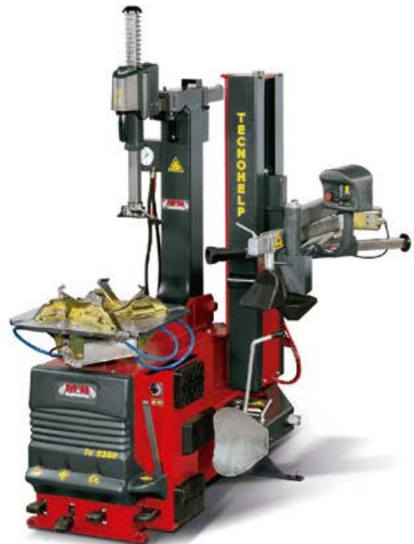
Desmontadora automática con sistema IT (inflado tubular), y unidad de brazo ayudante. Ideal para trabajar neumáticos modernos (UHP y Run Flat), Sistema de doble velocidad con control a pedal. Cuenta con sistema Motoinverter de doble velocidad (10 - 17RPM), las revoluciones se ajustan a un torque constante, garantizando ahorro en tiempo de trabajo.
