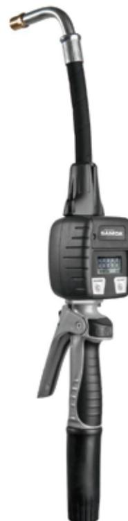
Pistola digital cuenta litros de aluminio. Cuenta con cámara volumétrica de engranajes ovales y contador electrónico de lectura digital multifunción para un fácil control del volumen real entregado. Su empuñadura es ergonómica con material antideslizante. Su gatillo de regulación de caudal cuenta con bloqueo, éste permite que se tenga un caudal sostenido y evita accidentes en la entrega. Cuenta con indicador parcial, total y modo trip.
