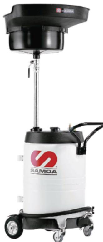
Recuperador para fluidos usados de autos y camionetas. Cuenta con un estanque de 100 litros. Su descarga es mediante presurización con aire comprimido a 0.5 bar utilizando inflador de neumáticos y válvula limitadora. Cuenta con una bandeja porta herramientas/objetos moldeada sobre el estanque. También, con un embudo regulable con parrilla anti salpicaduras con prolongación excéntrica orientable 360°.
