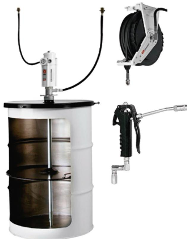
Kit neumático de grasa para tambor. Cuenta con pistola análoga, carrete con manguera de 15 metros, manguera de conexión, filtro para agua, tapa de tambor, membrana seguidora de tambor y bomba neumática relación 55:1.
