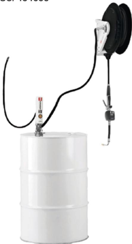
Kit neumático de conexión directa a tambores de aceite. Cuenta con carrete, manguera de conexión, pistola digital cuenta litros, y bomba neumática. Indicado para uso de todo tipo de aceites. La bomba permite añadir posteriores salidas de fluido con enrollador y pistola cuenta litros.
