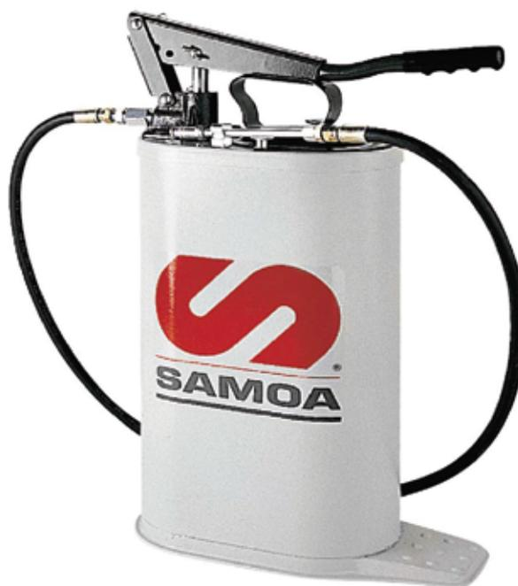
Bomba de engrase muy robusta, de gran rendimiento, con palanca ajustable en tres diferentes posiciones alternativas. Para su utilización en cualquier condición medioambiental con grasas hasta grado NLGI 2 y/o aceites de altaviscosidad. Su entrega por ciclo de 20, 15 o 10gr segúnposición de palanca lo hace muy atractivo al mercado.
