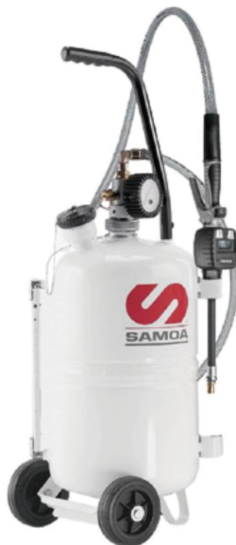
Dispensador móvil autónomo, cuenta con estanque de 25 litros para lubricante e indicador de nivel. La unidad debe ser presurizada con aire comprimido, conectando un inflador de neumáticos a la válvula de carga. Esto permite que el equipo entregue el lubricante gradualmente al accionar el gatillo de la pistola cuenta litros.
