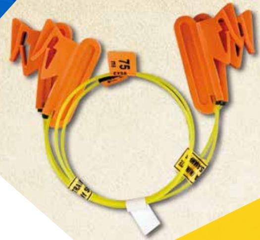
El retardo de superficie es un sistema no eléctrico de retardo bidireccional, compuesto por dos detonadores ensamblados en conectores plásticos y unidos por un tubo de choque transmisor de señal.
