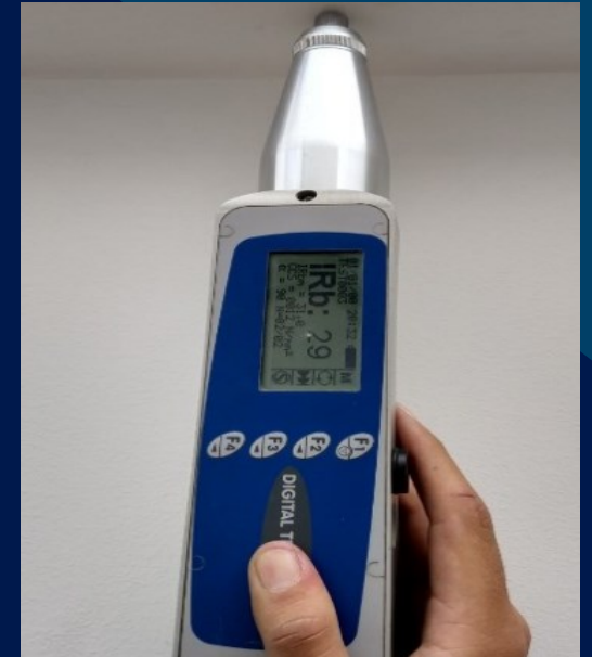
Ensayo de esclerómetro para la determinación de resistencia a la compresión de concreto de manera no destructiva
