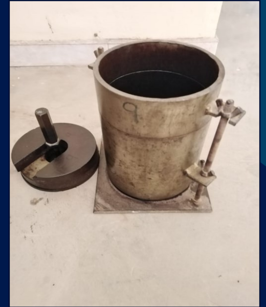
Ensayo de CBR
