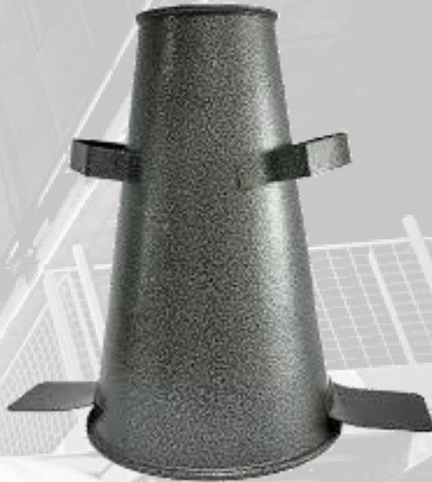
Diámetro de la base mayor: 200 mm, Diámetro de la base menor: 100 mm, INV E 404 | NTC 396 | ASTM C 143-192
