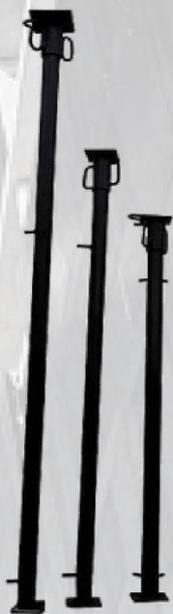
PARAL METALICO DE 2.00 MTS PARAL METALICO LARGO TELESCOPIO DE 2,00 MTS FLAUTA DE 2 MT EXTENDIBLE A 3,70 MTS TUBERIA AGUA NEGRA 2"X0,90 mm CALIBRE, DIAMETRO FLAUTA 1 1/2 X 0,90 mm DE CALIBRE TUERCAS EN TUBERIA PETROLERA, GANCHOS EN DIAMETRO DE 1/2" PINES O TACHES DE 1/2", PLATINAS DE 1/4 DE 12X12(calibre o espesor)
