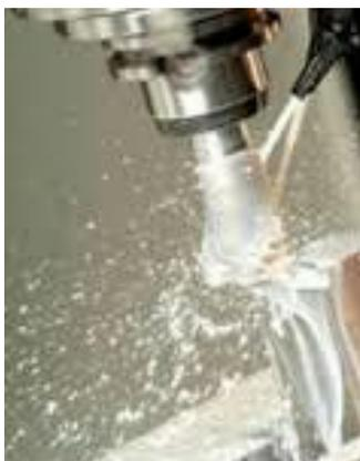
La línea **EMULSOL** es una serie de aceites de corte solubles diseñados para refrigeración de metales durante los procesos de mecanizado. Fabricado con aceites minerales refinados y aditivos importados que le confieren características de enfriamiento excelentes así como sobresalientes propiedades anticorrosivas antibacterianas y de gran lubricidad.
