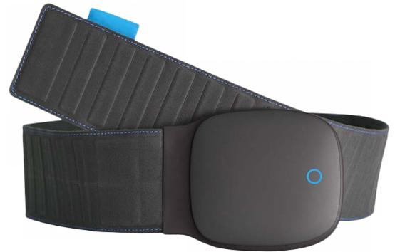
Es un dispositivo inteligente que monitorea, rastrea y analiza la calidad del sueño. Tiene sensores de grado médico y estructura patentada, mide con precisión el tiempo de sueño, la frecuencia cardíaca, la frecuencia respiratoria, el movimiento corporal y los ciclos de sueño. A través de una conexión Bluetooth sincronizada automáticamente, una aplicación analiza sus datos de sueño.
