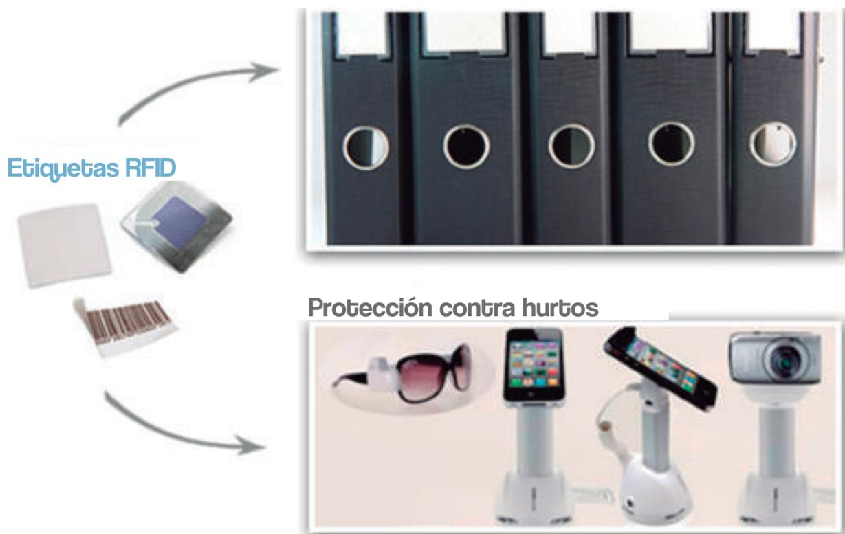
Las etiquetas RFID, son dispositivos pequeños los cuales pueden adherirse a un producto, contienen antenas para permitirles recibir datos por radiofrecuencia desde un emisor-receptor RFID. El objetivo principal que cumple dicha tecnología es transmitir datos de un objeto, así evitando hurtos.
