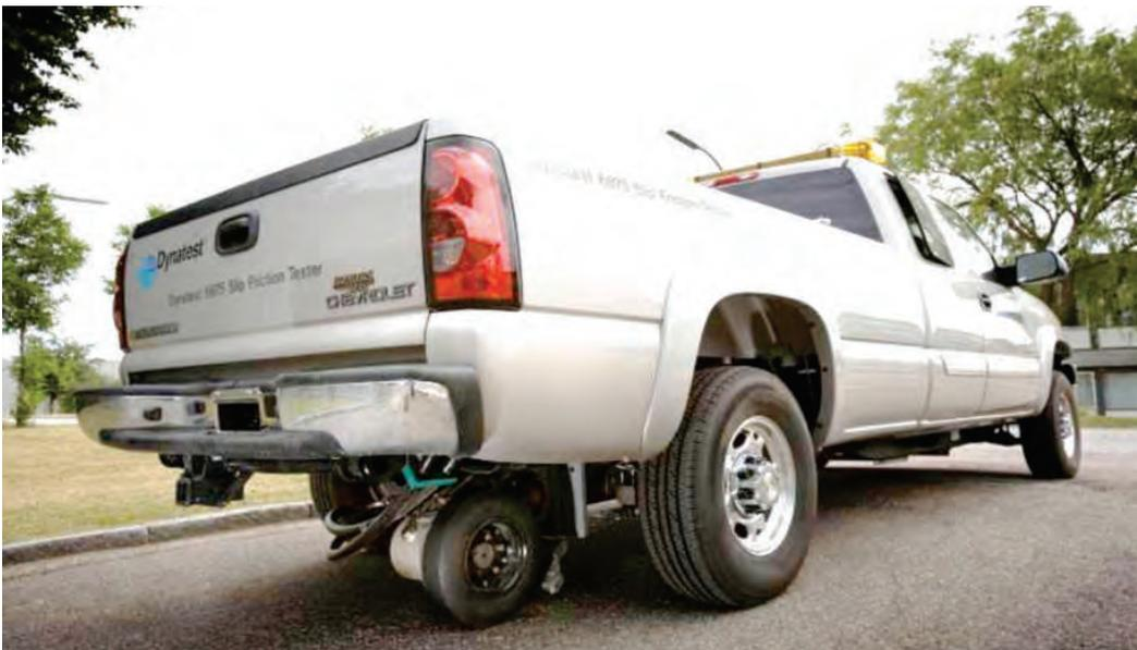
Medidor de Fricción
