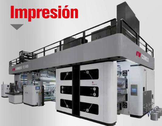
8 colores de alta definición, 400 ml/ min, 1320 ml ancho útil.
