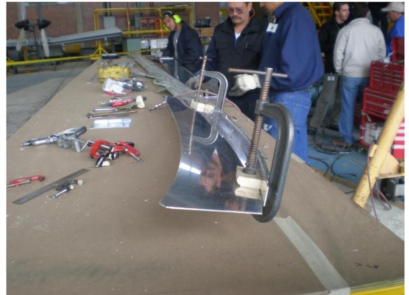
*Fabricación de guías de taladro para perforación de partes estructurales.*
