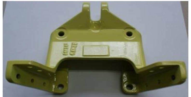
*Fabricación brazos de soporte del seguro del tren de nariz, mantenimiento y tratamiento anticorrosivo de sus partes estructurales.*
